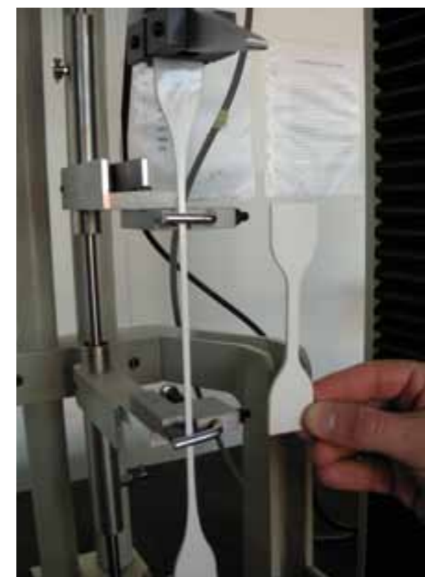
La membrana impermeabilizzante della linea MasterSeal M 689 durante il test di trazione secondo ASTM D638. Si noti l'elevatissimo allungamento elastico del materiale.
