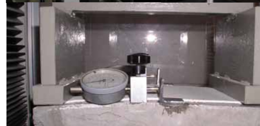
Test di crack bridging statico secondo UNI EN 1062/7. Superata la classe massima A5 pari a 2,5 mm senza fessurazione. Si noti come il supporto in c.a sia completamente fessurato mentre MasterSeal M 689 si presenta in condizioni perfette. Le fessurazioni infatti non riescono a passare dal supporto all'elastomero.
