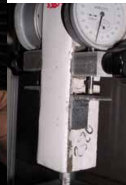
Test di crack bridging dinamico secondo UNI EN 1062/7. Superata la classe massima B4.2 (1000 cicli a 0,03 Hz con apertura fessura massima w_o = 0,5 mm e minima w_u = 0,2 mm trapezoidale; quindi altri 20.000 cicli a 1 Hz con movimento della fessura dipendente dal carico w_l = 0,5 mm sinusoidale) senza fessurazioni.
